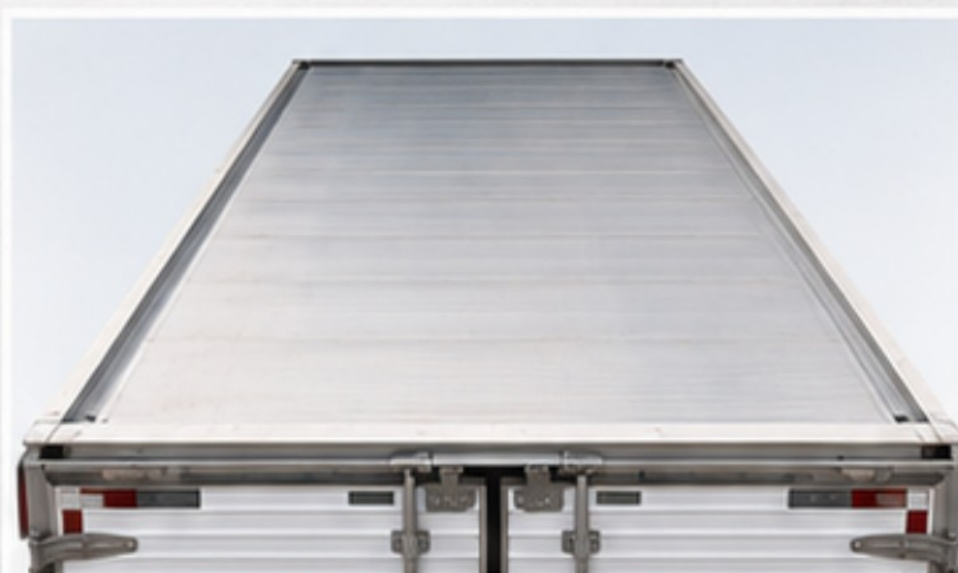
Teto em chapa de duralumínio única, sem emendas, garantindo melhor vedação.
