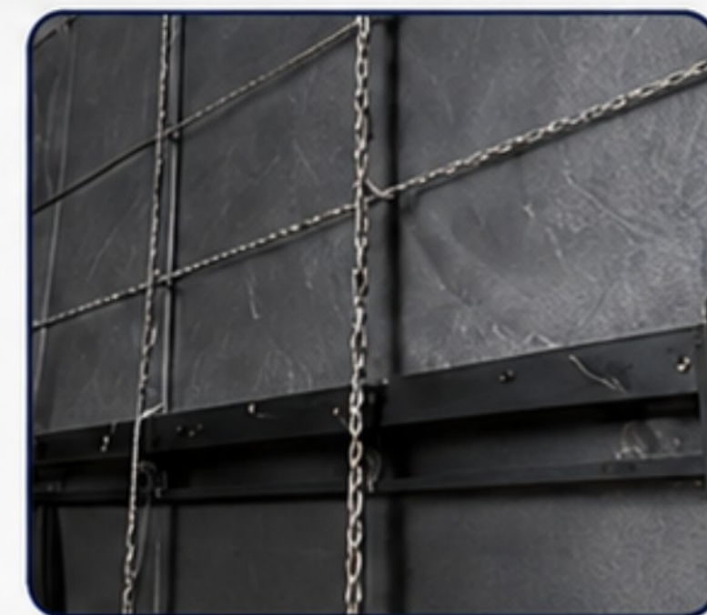
Correntes internas para segurança da carga.
