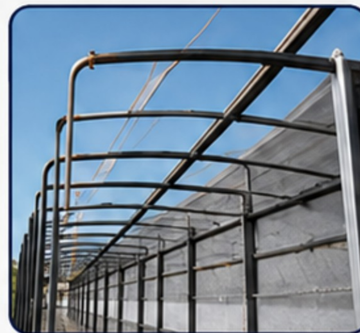
Arcos centrais com estrutura reforçada.
