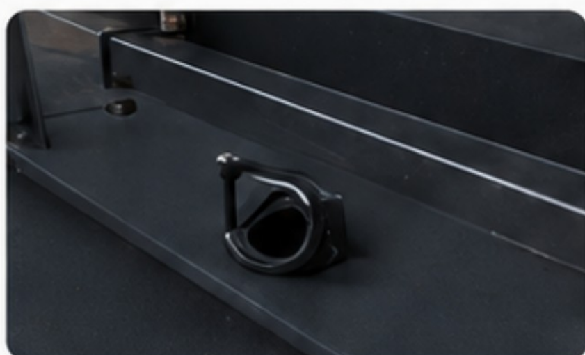
Gancho de amarração retrátil, embutido no assoalho (opcional).
